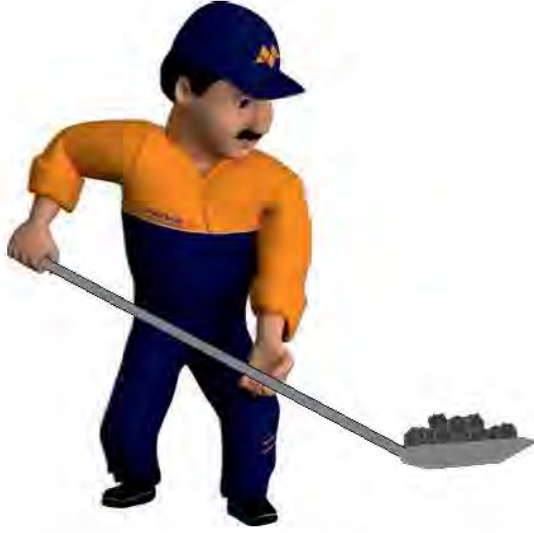
Şekil-16: Izgaranın, boş olan ön kısmına yeterli oranda ham kömür yükleyin.
