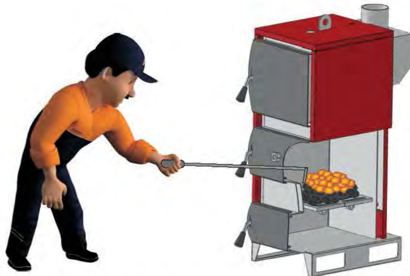
Şekil 15: Y akıtı, akkor hale geldikten sonra Gelberi ile arka tarafa itip, ön tarafta yeni kömür yükemesi için yer açın.
