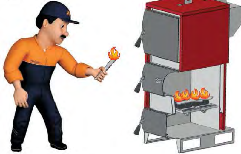
Şekil 14: T ahta parçalarının tutuşturun. Tahta parçaları iyice tutuşunca fanı kısık devirde çalıştırın.
